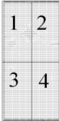
圖十：將圖十中所取得特徵區塊獨立出來，以分割 2^2 個定位區為例加以說明。將每個定位區給予編號。
