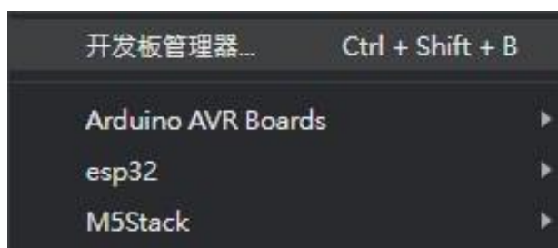
(圖 5-9 開啟工具找到開發板管理器(boards manager))
