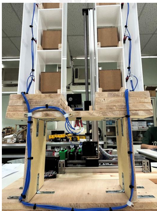
圖 9 建築後方配線狀況
