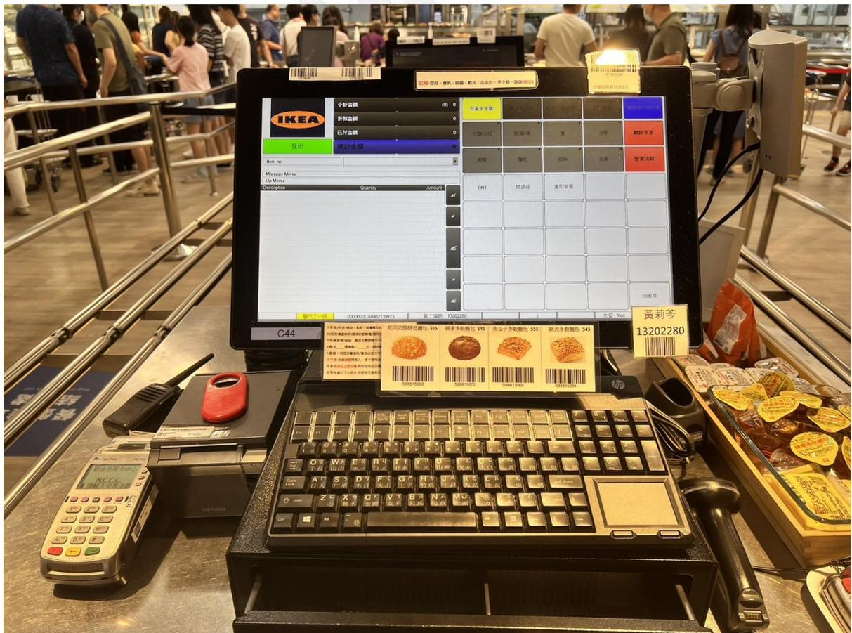
圖 4-4 條碼槍、發票機、錢箱、鍵盤、信用卡機
