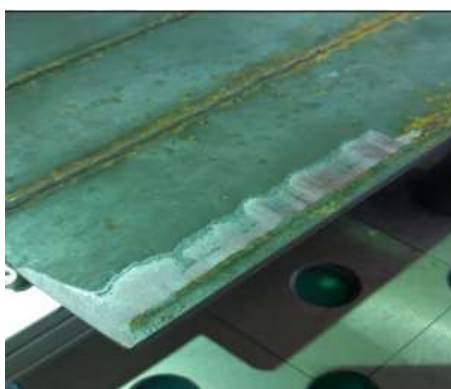
圖 6、焊道加工工件之實作材料
