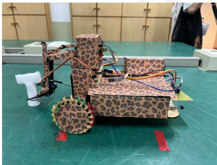
圖 3.10 系統優化後之電路板整合與雙層車體理線實體圖
