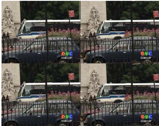
圖 11.上二張為未加浮水印的”Bus” video sequence 畫面，PSNR 值皆為 45.1205dB，下二張為加入浮水印的畫面，由左而右 PSNR 值為 42.1102dB 和 38.1308dB。
