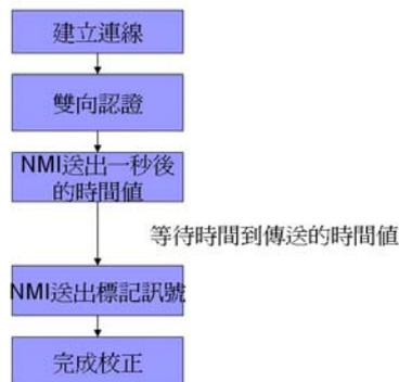
圖 2、校正時間通訊流程
