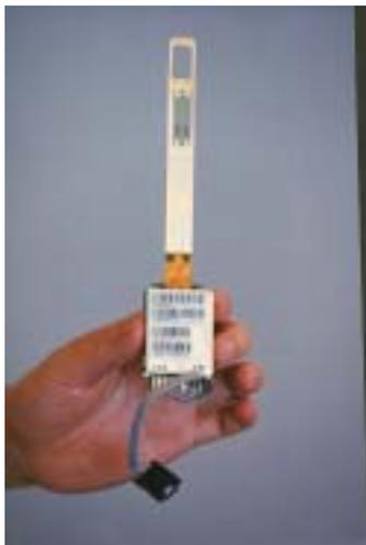
圖 3：Vaisala RSS901 溫濕壓感應元件
