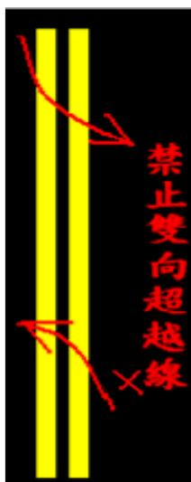
圖 1-4 彎道禁止超越線
