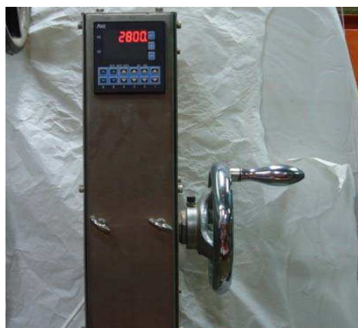
照片3-4 顯示式管路手動矩形閘閥
