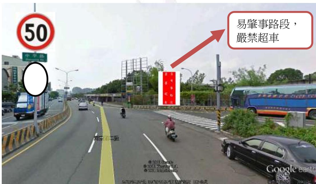
圖 3.11、河南路與中平路交會處，增設 50km/h 速限、反光鏡以及「易肇事路段，嚴禁超車」標誌
