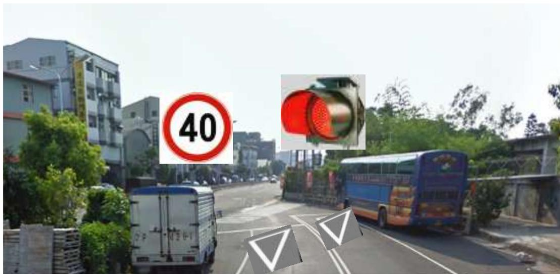
圖 3.1、中平路設置閃光紅號誌、停讓標線；並設定速限
