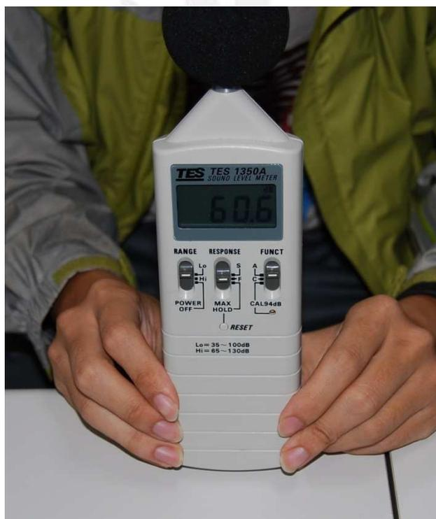
圖(十二) 用音壓計測量環境音壓
