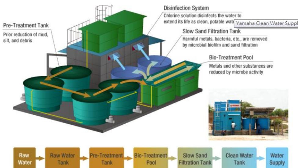
圖 5-4 YAMAHA Motor 發展之水淨化系統
