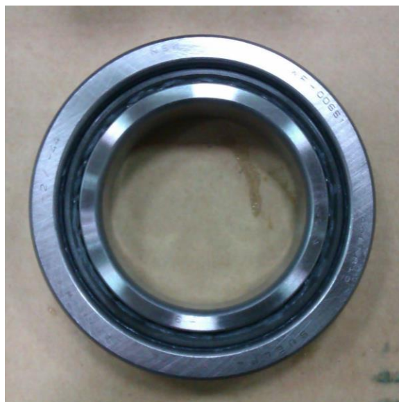
圖 3.7: 高速主軸測試平台使用軸承(DDS-BT30)。
