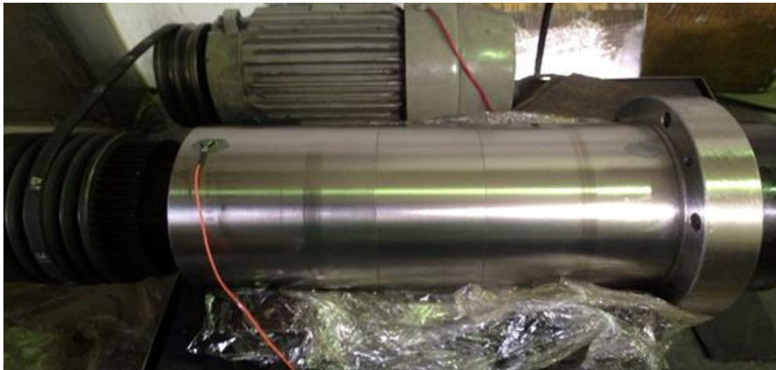
圖 1.2.2：將加速規直接貼附於高速主軸外殼上。
