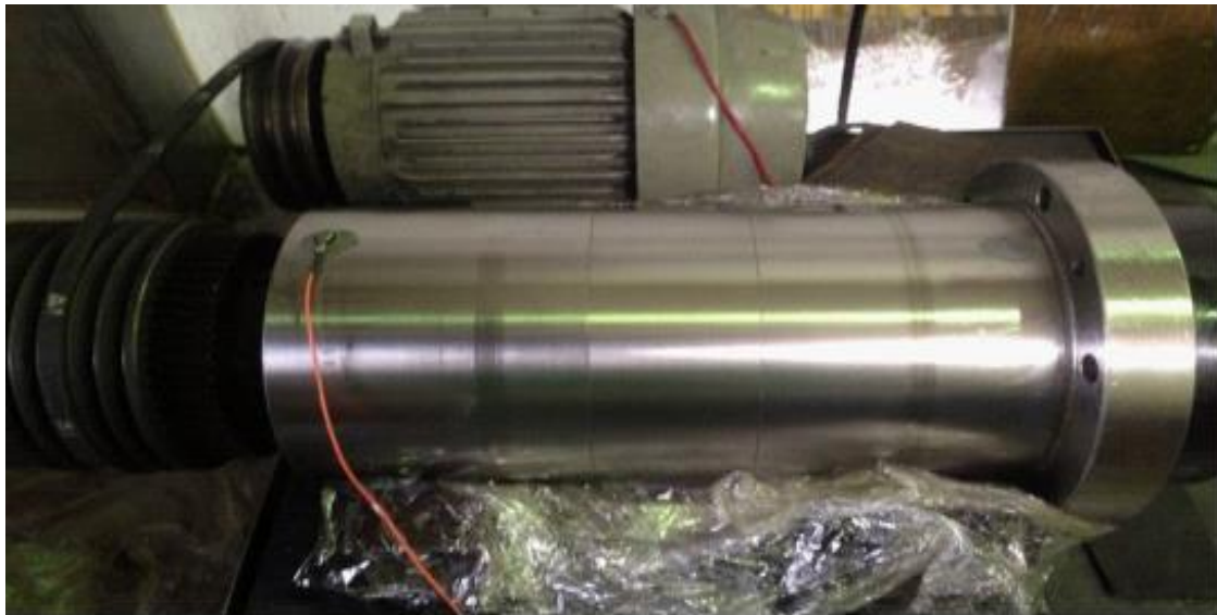
圖 1.2.3：前方點為測試 B 點，為主軸後軸層。
