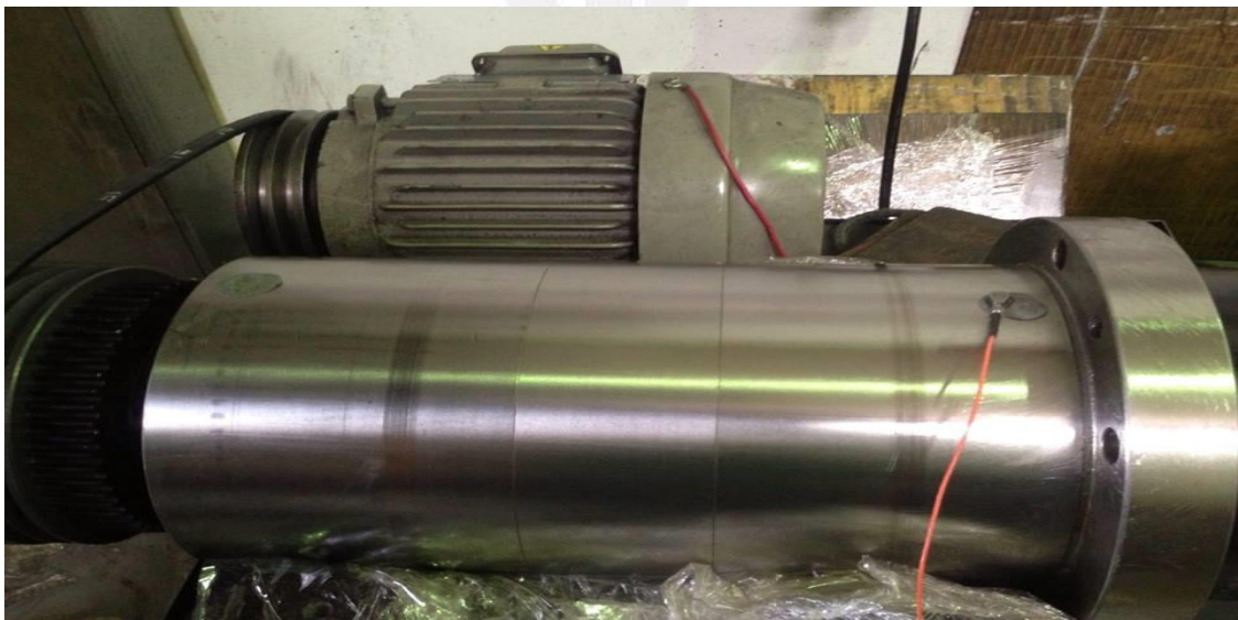
圖 1.2.4：後方點為測試 A 點，為主軸前軸層。
