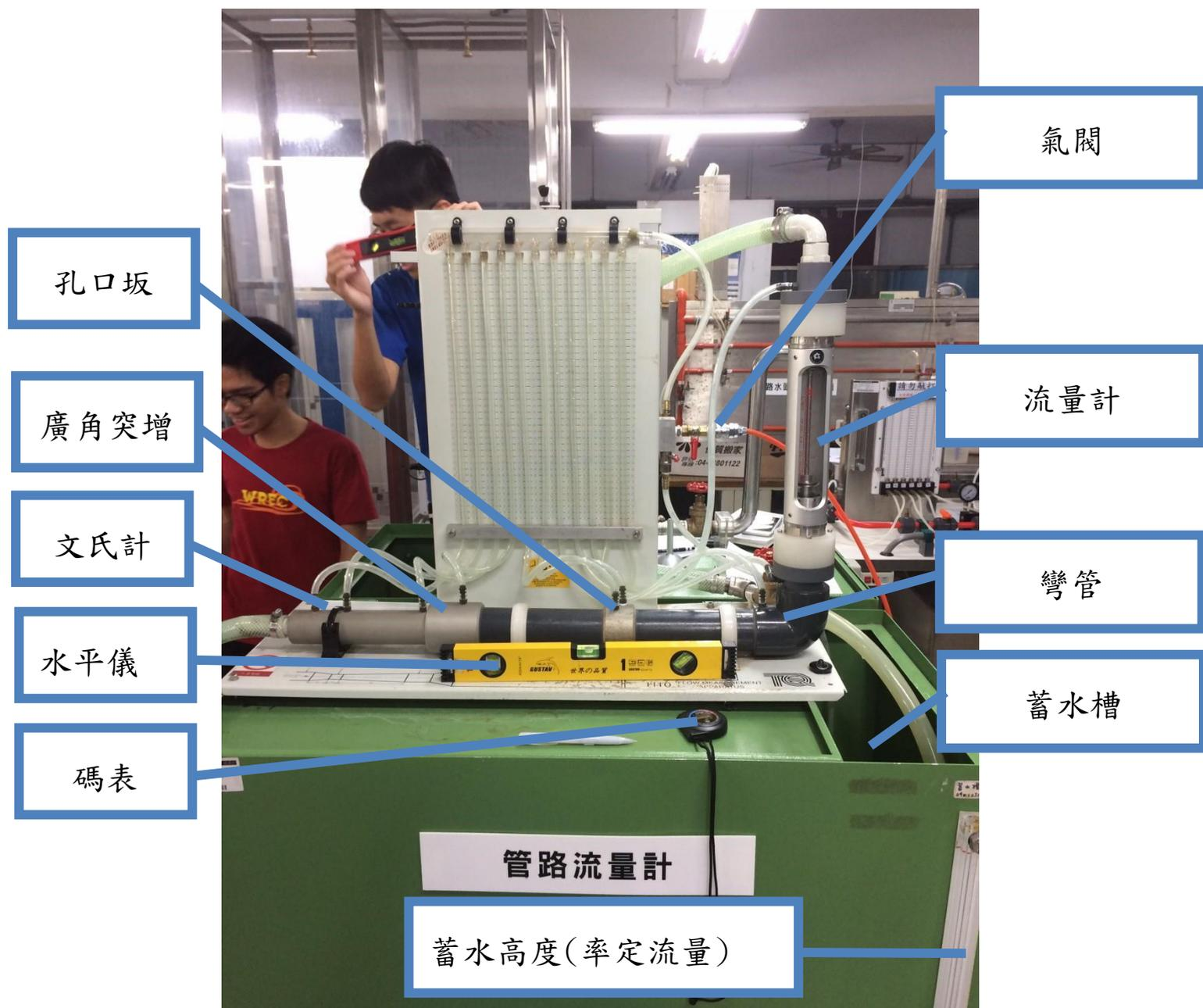
水自右邊出水口進入儀器後上升，再自上端左邊經量水孔口流回試驗台之蓄水水箱，構成一個循環單元。儀器上有九個壓力孔口上以透明軟塑膠管集合構成一集合封閉試壓力計。板之上端有一空氣孔閥門，調整壓力計內之空氣含量。儀器左上端有一流量控制閥門。儀器下方平板的四腳分別有四個調整支腳，用以調整儀器成水平。
