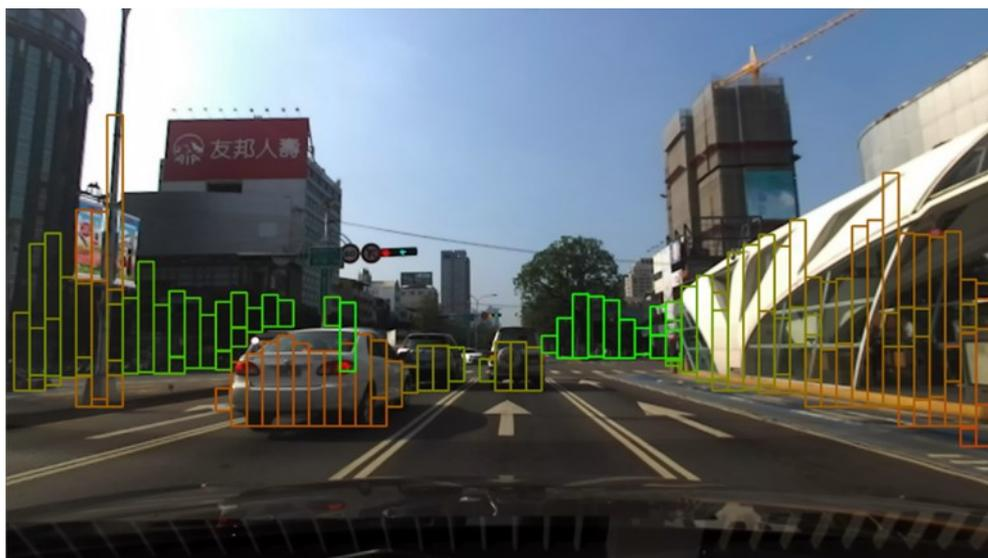
圖 3-3-15、障礙物偵測最終結果
