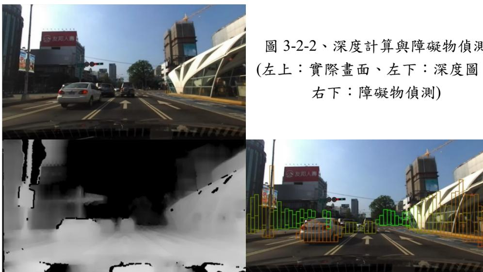
圖 3-2-2、深度計算與障礙物偵測
