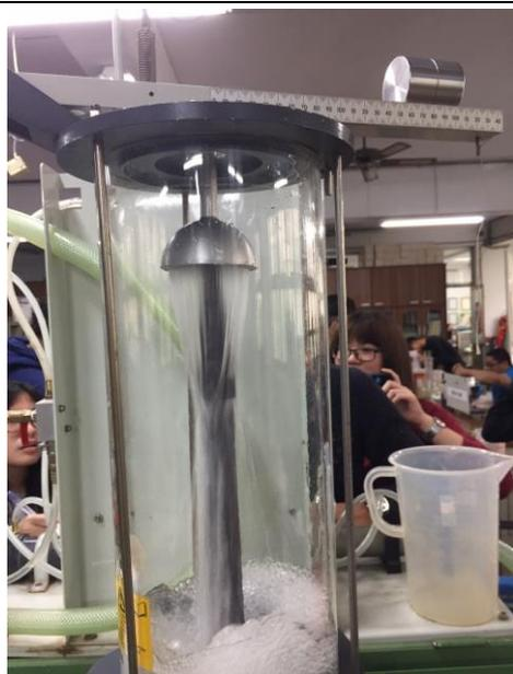
圖八 噴流撞擊半球杯模型
