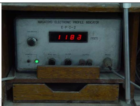
照片 4-2 超音波剖面量測儀
