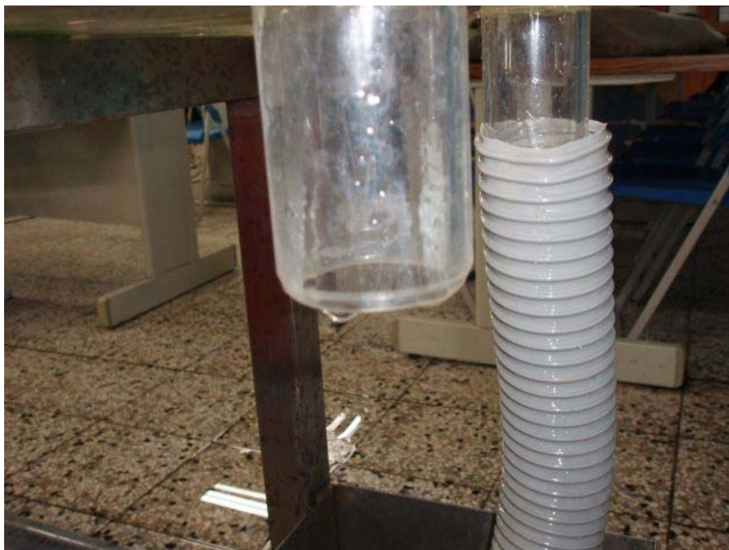
圖二十一. 用體積時間法量流量用的出水處
