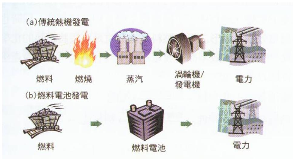
利用內燃機來產生電的方式具有低效率以及污染氣體排放的缺點。燃料電池透過一個潔淨的方式高效率發電（ $\sim 83\%$ ），同時具有低污染排放特性，能取代傳統內燃機發電方式。
