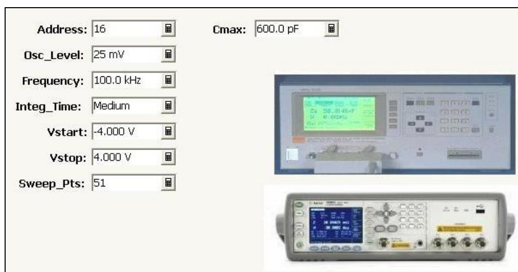
圖 3-3.7 安捷倫 E4980A 設定頻率 100KHz、電壓掃過範圍 \pm 4\text{V} 。
