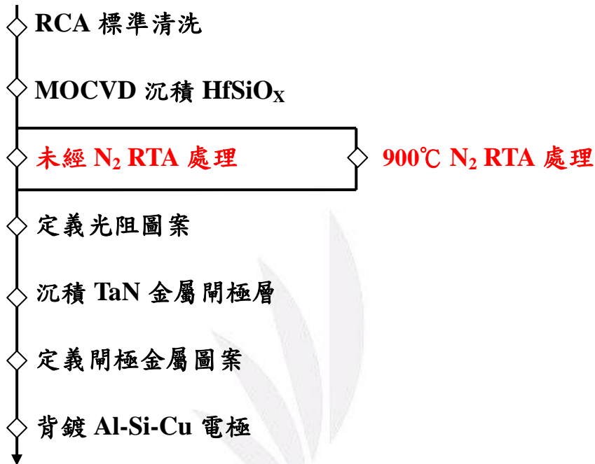
圖 3-1.1 HfSiO x MIS 結構簡易流程
